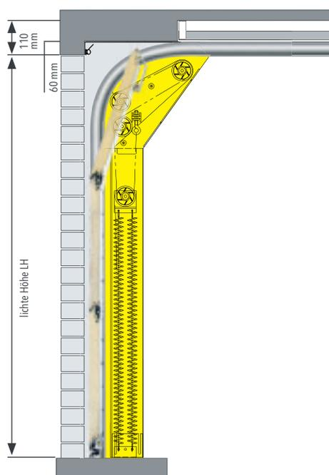
**Torsionsfeder vorne (6) mit Lüftungsfunktion**
