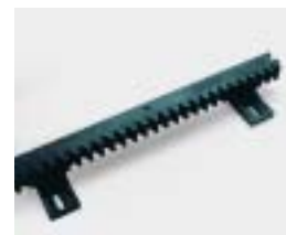
CP: Kunststoffzahnstange 22x22 Modul 4, aus hochfestem Kunst- stoff mit Stahlkern 8x8, mit Langlöchern, 1 m - Stücke
